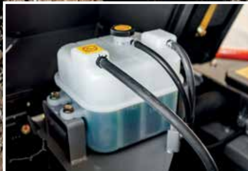
De expansietank voorkomt oververhitting van motoronderdelen.
