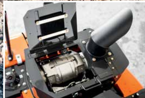
Het SCR-systeem vermindert uitstoot en brengt het geluidsniveau omlaag.
